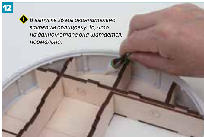
12 Также нанесите немного секундного клея на места соединения основания и облицовки.
